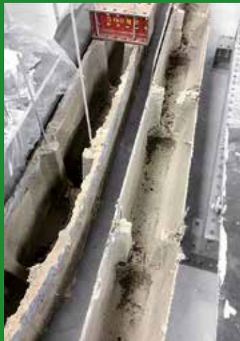
GEREALISEERDE OPPERVLAKTEXTUREN MET VACUUMATICS (ONDER) EN EEN IMPRESSIE VAN EEN VACUÛMCONSTRUCTIE TOEGEPAST ALS BEKISTINGSYSTEEM (LINKS) VOOR DE PRODUCTIE VAN EEN INNOVATIEVE BETONNEN KANO (RECHTS). (GEREALISEERD DOOR STUDIEVERENIGING KOers, TU/e)
