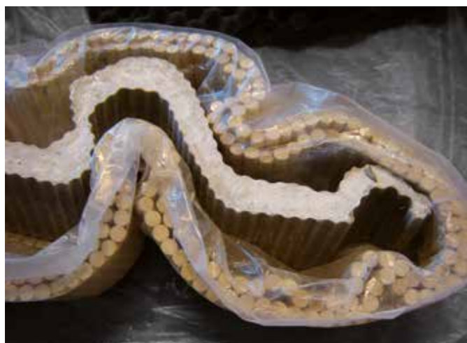
5. Boven uiteenlopende oppervlaktetexturen en onder complexe vormen in beton, geproduceerd met vacuumatic formwork [7].
