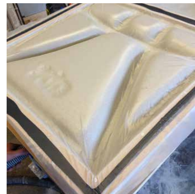
7 - 10. Van boven naar beneden: De uit EPS gesneden moedervorm. Het vacuümvormen (dieptrekken) van de folie over de moedervorm. Het opvullen van de randbekisting met zand. De moedervorm laat een afdruk achter in de vacuüm-gestabiliseerde zandmal.
