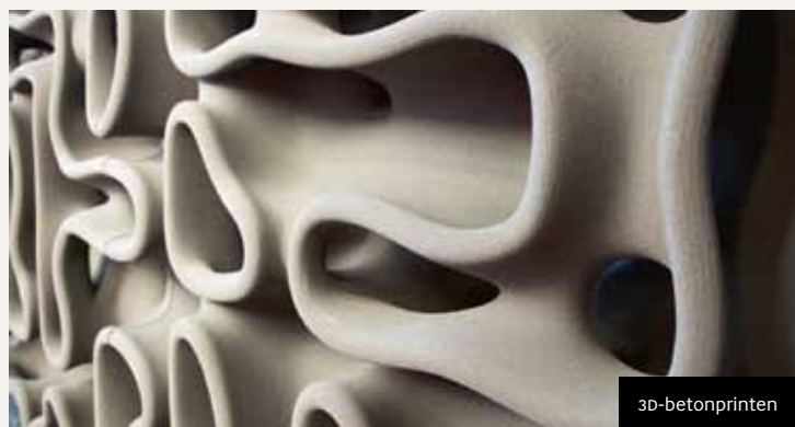
Het vervormen van 'vacuumbeton' aan de TU/E
